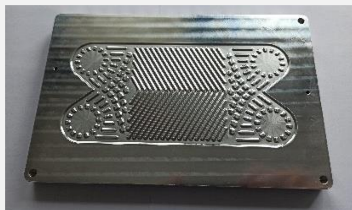
Prägestempel zur Herstellung strukturierter Platten
